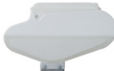
VEGA PROFI vetőgép gabonatartrálya 52 literes kapacitással.
