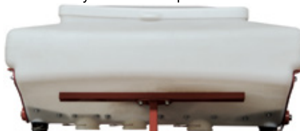
VEGA PROFI vetőgép műtrágyatartrálya 180 literes kapacitással
